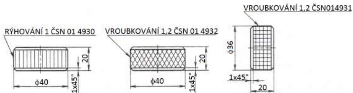
Obrázek 154. Kreslení a kótování, rýhování příčné
