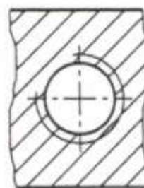
Obrázek 50. Kreslení vnitřního závitu v neprůchozí díře
