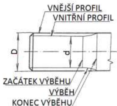
Obrázek 139. Kreslení drážkového hřídele v podélném pohledu
