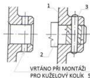
Obrázek 14. Kótování díry pro kuželový kolík Obrázek 15. Společné obrábění spojovaných součástí
