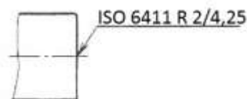
Obrázek 138. Znázornění středícího důlku, který může a nemusí zůstat na součásti
