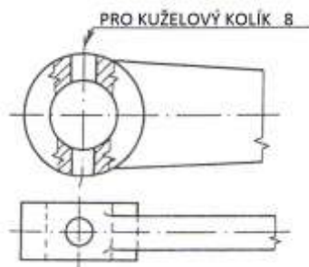
Obrázek 14. Kótování díry pro kuželový kolík Obrázek 15. Společné obrábění spojovaných součástí
