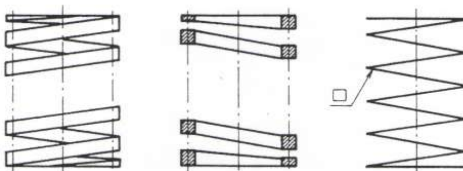
Obrázek 92. Pružina šroubovitá tlačná z drátu čtvercového průřezu a) v pohledu, b) v řezu, c) schematicky
