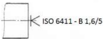
Obrázek 137. Znázornění středícího důlku, který nesmí zůstat na součásti
