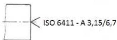
Obrázek 136. Znázornění středícího důlku, který musí zůstat na součásti
