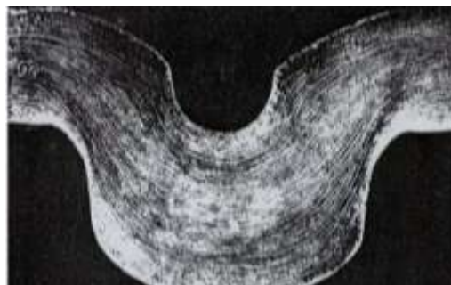
obr. 23 Vláknitost vzniklá při kování
